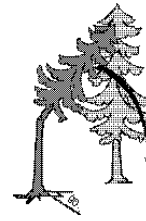
Figure 20 : Abattage sur le côté d'un arbre partiellement cassé et encroué
